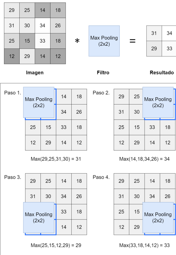
Figura 2.3: Ejemplo de aplicación de la operación de pooling de valor máximo sobre una imagen, con un stride igual a 2.
