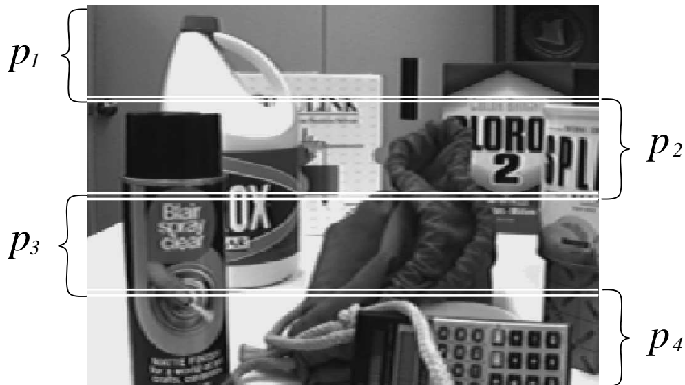
Figura 3.1: Imagen dividida para cuatro procesadores con traslapes para calcular de manera correcta las derivadas sin perder información por causa de utilizar máscaras.
